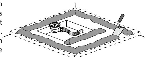
Für bestimmte Duschwannen-Modelle liegen spezielle Einbuanleitungen bei, in denen die Maße der Bodenöffnung und die Position des Bodenablaufanschlusses definiert sind.
