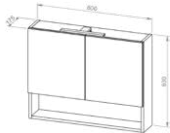
Viseći ormarić BASIC PLUS 80 - LED rasvjeta - prekidač i utičnica unutar ormarića - 1 polica
